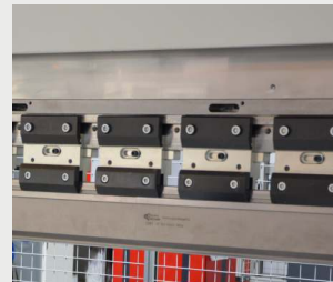
Система крепления пуансона Amada – Promecam (System)
