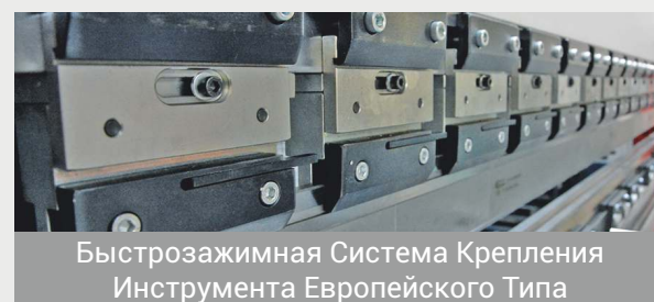
Пневматическое Крепление Инструмента Производства Dener
