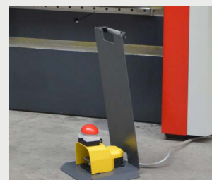
Система управления педалью с кнопкой аварийного останова
