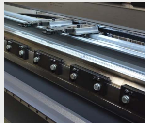
Система крепления матрицы Amada – Promecam (System)
