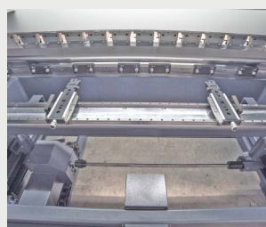
Двухосевой задний упор (X-R)
