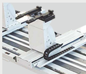
Шестиосевой задний упор ATF (X1 X2 R1 R2 Z1 Z2)
