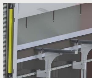
Световое ограждение, согласно требованиям безопасности CE
