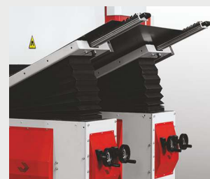
Электромеханические направляющие с функцией отслеживания гибки листа
