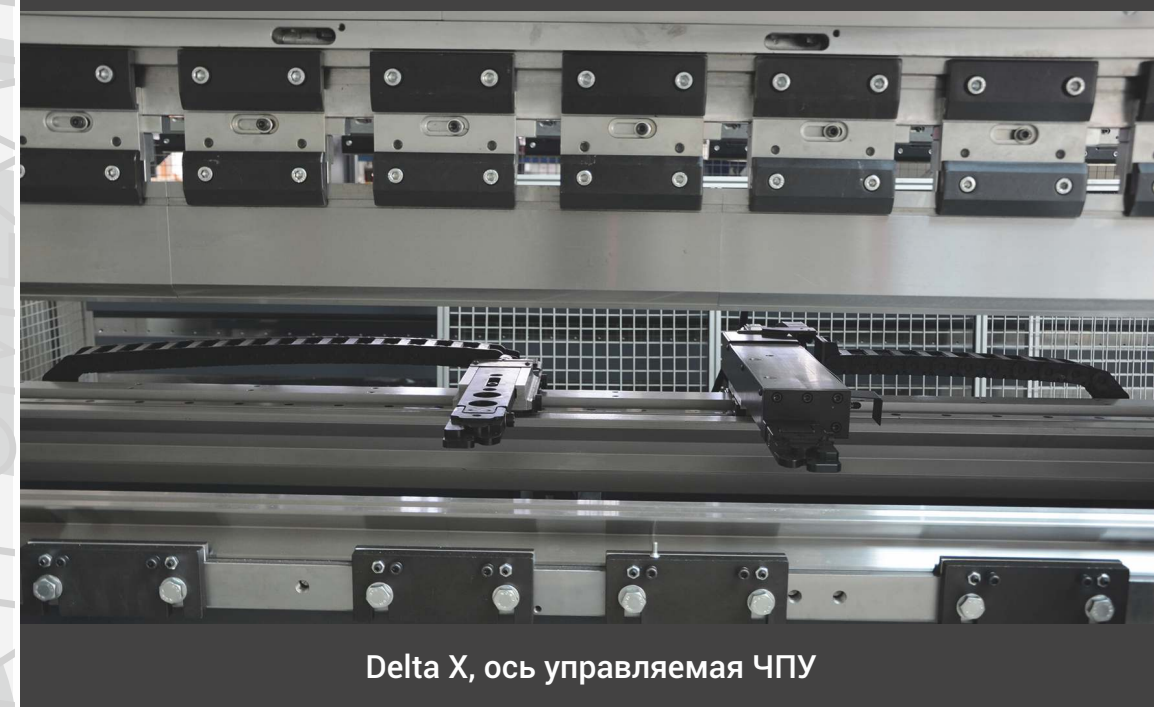
Задний упор (X-R-Z1-Z2)
