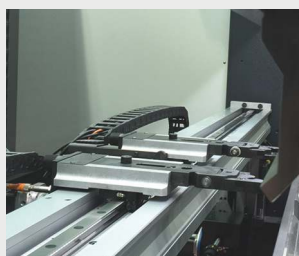
Пятиосевой задний упор (X1 X2 R Z1 Z2)
