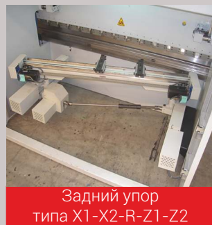
Шестиосевой задний упор типа ATF
