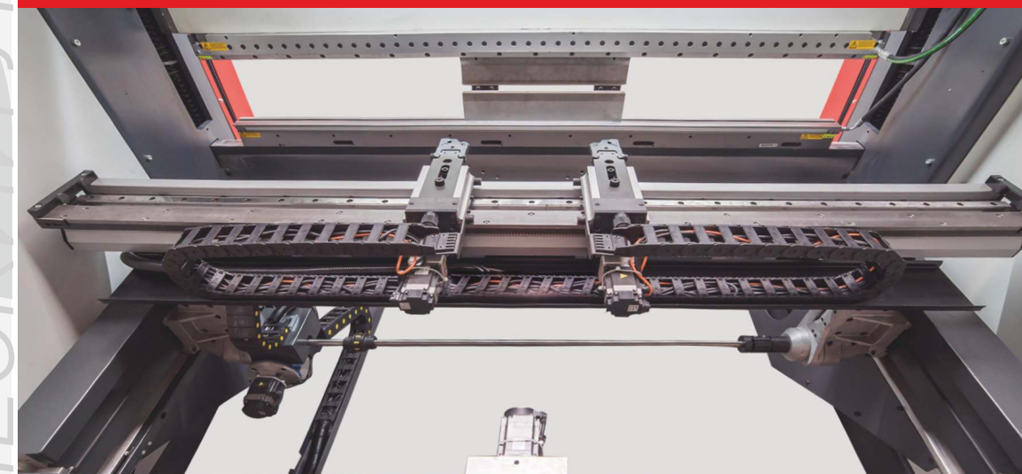
Задний упор (X-R-Z1-Z2)
